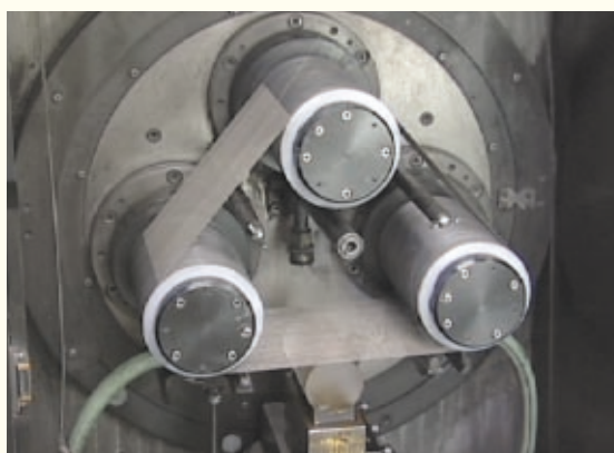
電着ダイヤモンドワイヤによるサファイアインゴットのスライス
