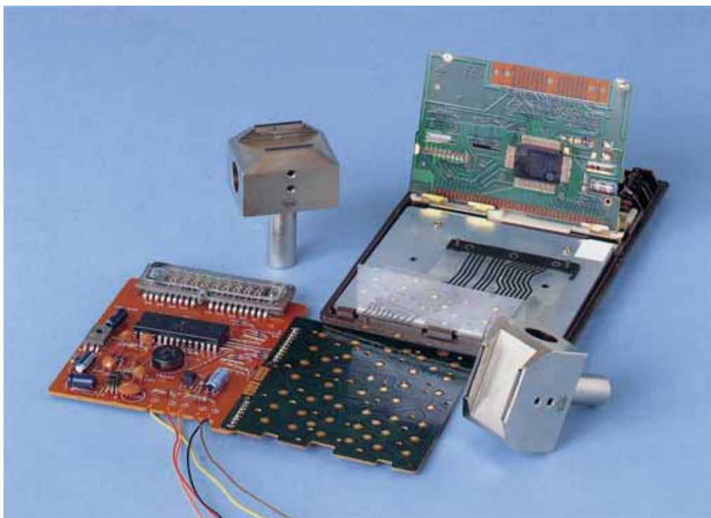
各種電卓に使用されているICチップとOLB
